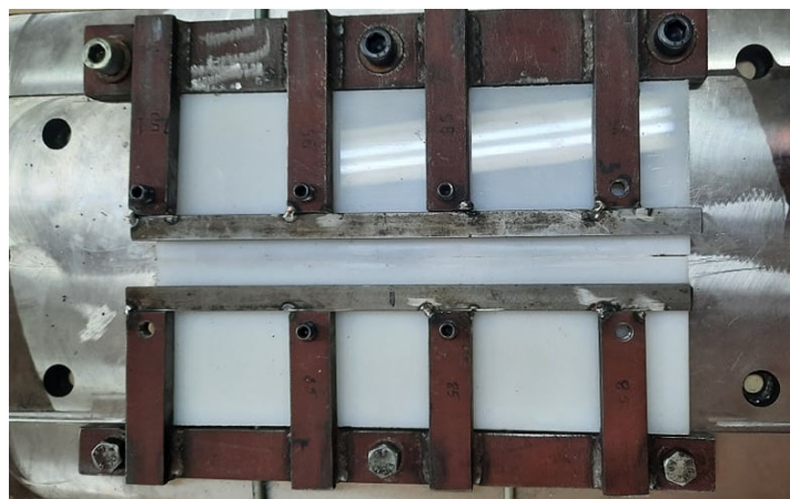
Фигура 1. Приспособление за челно заваряване чрез триене с разбъркване на полиетилен с дебелина 10 mm
