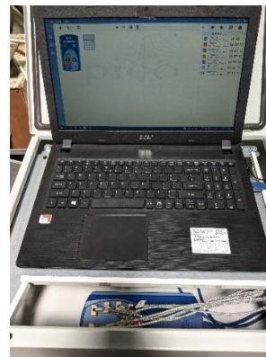
Фигура 6. Осем канален температурен регистратор Pico TC 08 с лаптоп към него
