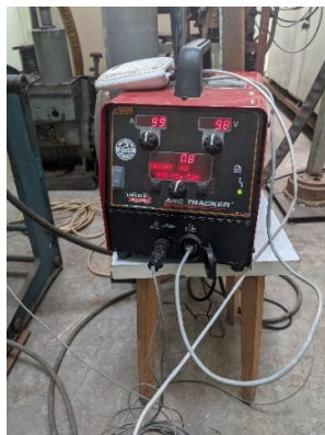
Фигура 5. Апарат за следене на заваръчния процес Arc Tracker и рутер
