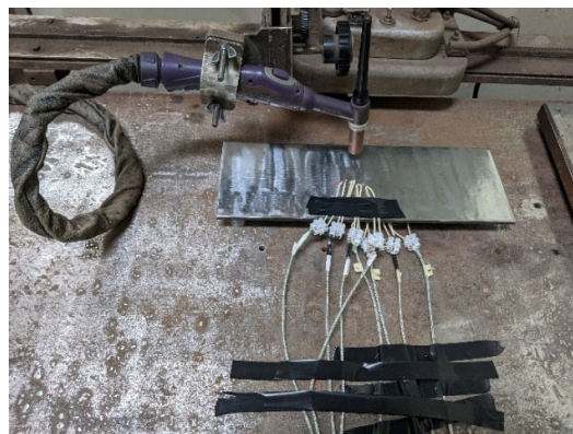
Фигура 7. Планка за наваряване, на която електроискрово са заварени 8 термодвойки – 4 от горната страна и 4 от долната, заваръчен трактор, държащ заваръчната горелка
