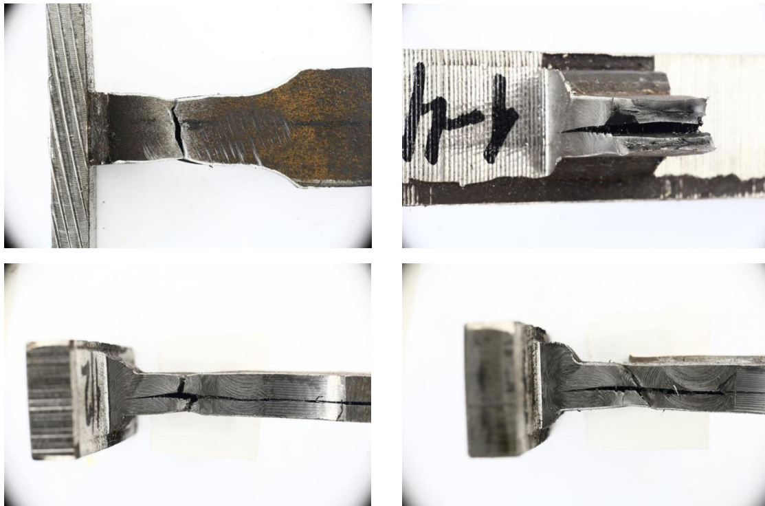
Фигура 6. Скъсване в основния материал.
