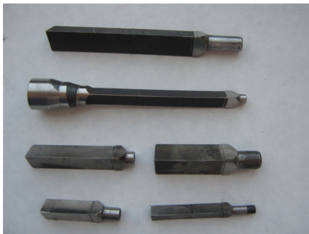
Фиг.2. Поансони, с които са проведени експерименталните изследвания
