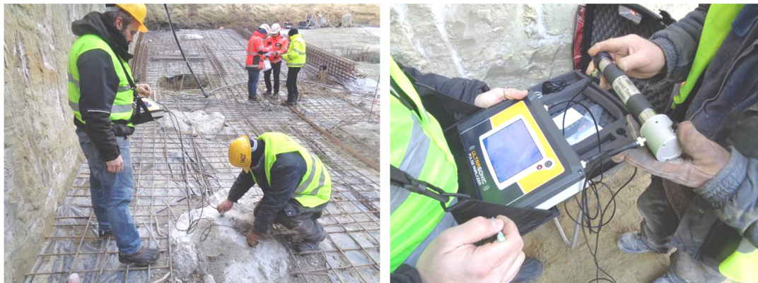
Фотоси 8 и 9. Едностранно повърхностно прозвучаване (ляво) и калибриране на УЗ апарат (дясно)
