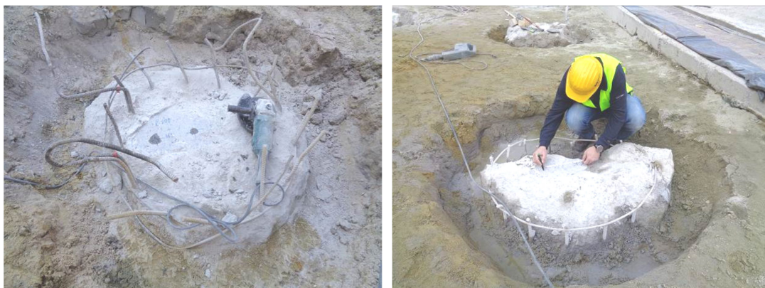
Фотоси 6 и 7. Повърхностна обработка (ляво) и маркиране на мерните бази (дясно)
