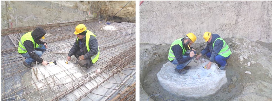
Фотоси 12 и 13. Моменти от изпитване на интегритета на пилотите с TDR-2 анализатор
