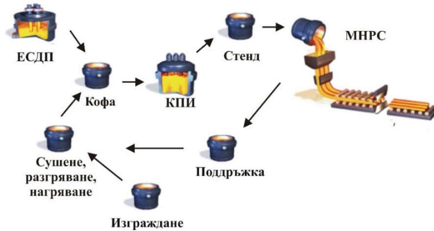
Фигура 1. Схема на работния цикъл на стоманодобивната кофа
