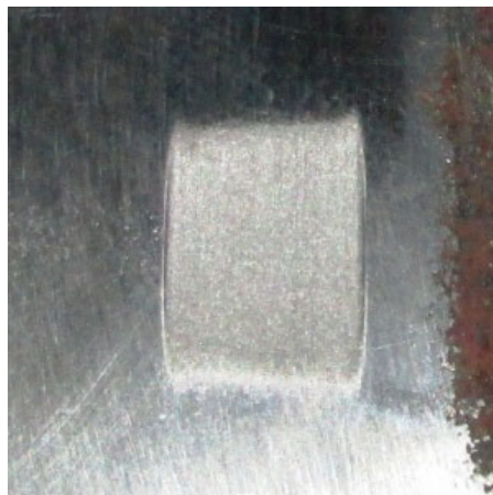
Фигура 5. Зона на износване вследствие на термична умора на инструментална стомана
