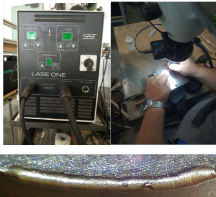
Фигура 3. Микроплазмено точново наваряване
