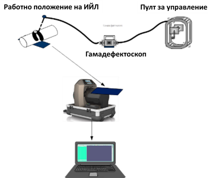
Фигура 1 Принципна схема на компютърна радиография
