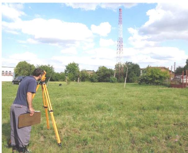
Фотоси 3.1 и 3.2 Измерване на вертикалността на кулите на NDB “BOZ” и ДМРЛ София с теодолит
