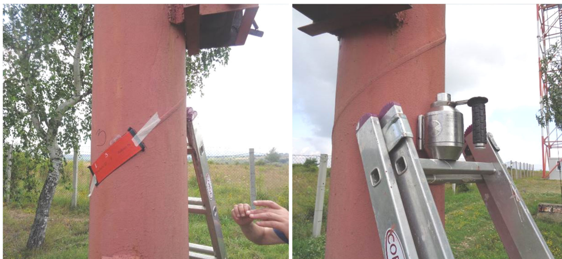
Фотоси 3.19 и 3.20 Филмова плака и гамадефектоскоп “GAMMA-MAT” R30, използвани при радиографичния контрол на спираловидните челни заваръчни шевове на тръбните кули
