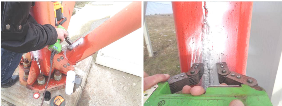
Фотос 3.17 и 3.18 БК на ъгли и челни заварки в дигонали и вертикали от стоманената кула на ДМРЛ София с „магнитно-прахов“ метод
