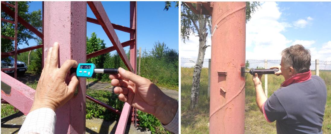
Фотоси 3.9 и 3.10 БК на якостта на конструкционната стомана с твърдомерни апарати – електронен (ляво) и механичен (дясно)
