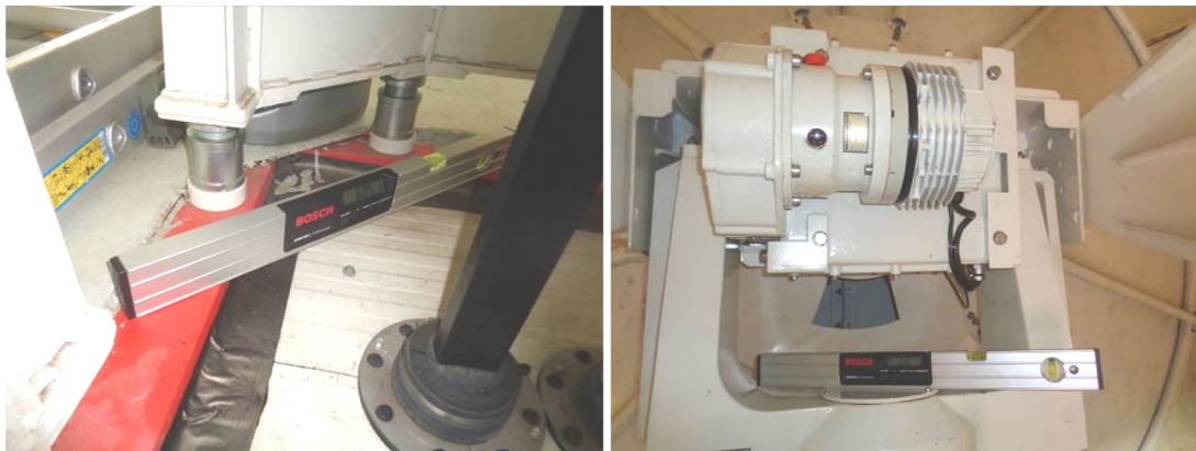
Фотоси 3.20 и 3.21 Контрол на хоризонталността на рамата и „темето“ на носача на антената на ДМРЛ София и ДМРЛ Варна
