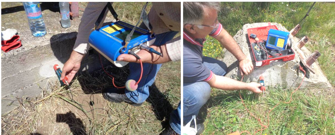
Фотоси 3.5. и 3.6 изследване на потенциала на бетона за корозия на армиравката във фундаменти на NDB "DWN" (ляво) и NDB "WAK" (дясно)
