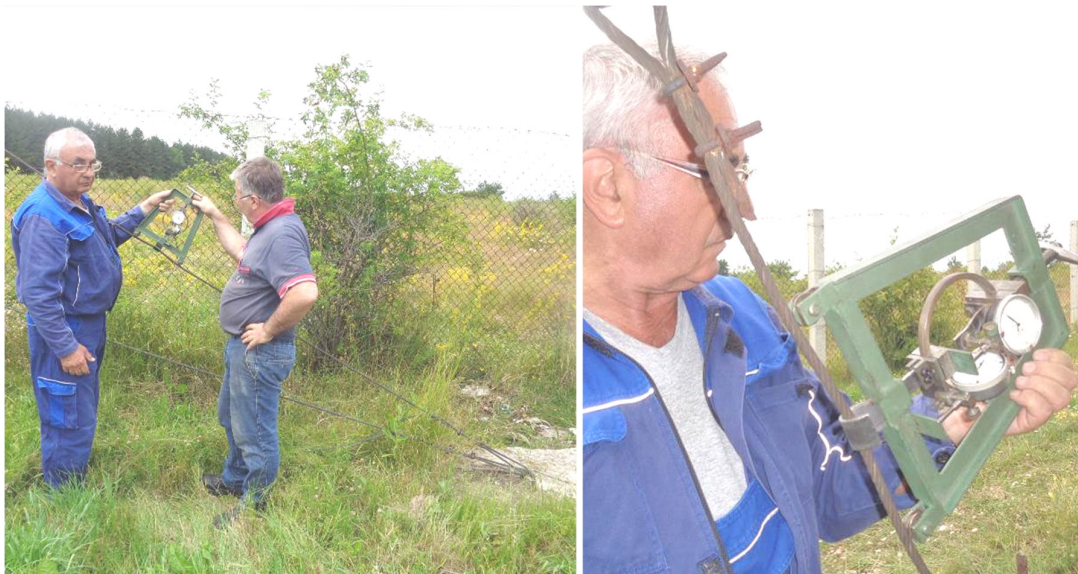
Фотоси 3.11 и 3.12 Определяне на усилия в стоманените обтегачи с динамометър за струни
