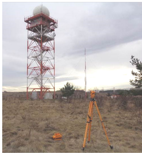
Фотоси 3.1 и 3.2 Измерване на вертикалността на кулите на NDB “BOZ” и ДМРЛ София с теодолит
