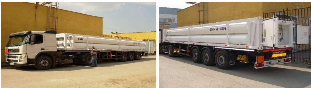
Фиг. 1. Многоелементен газов контейнер за транспортиране на компресиран природен газ, ТТ-08 - 2250 CNG.
