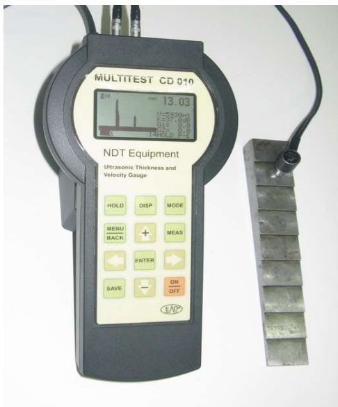
Фиг. 2. Външен вид на уреда и стъпаловидния еталон РКБ1
