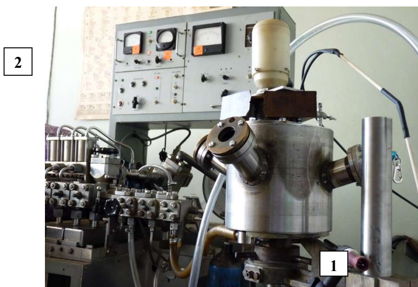
Фиг. 1 Аргоно- дъгова пещ (1), вакуумна установка СНИ-3 (2)
