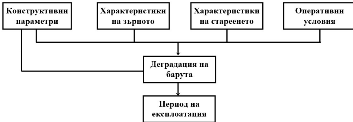
Фиг.3. Фактори, влияещи за периода на експлоатация на барутните двигатели.
