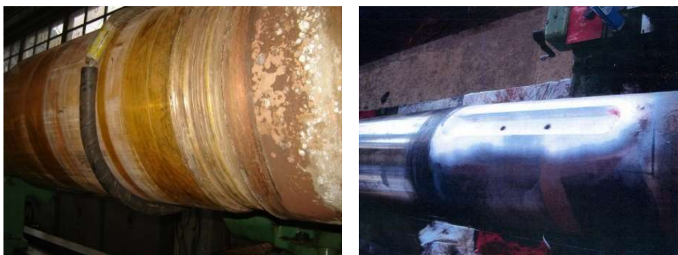
Фиг. 9. Дефектирал гребен вал – канали по бронзовата облицовка и пукнатини в шпонъчния канал, м/к Saint Fanouris
