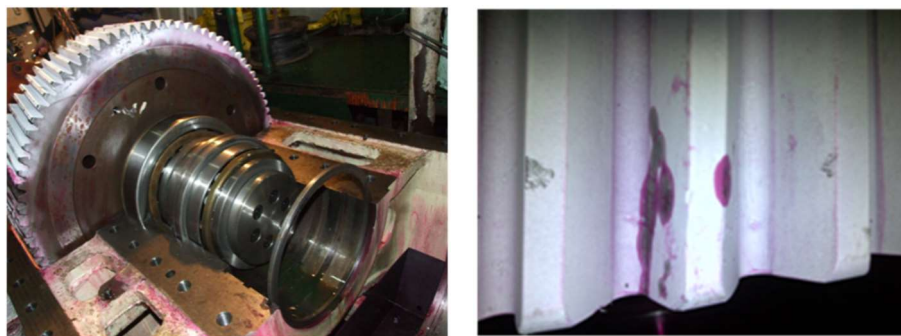
Фиг. 11. Открити дефекти - пукнатини по зъбното колело на пропульсивния редуктор, м/к Michelle 1
