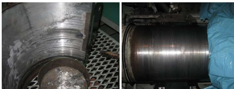
Фиг. 2. Завличане на лагерната композиция на м/к Wealth Reefer
