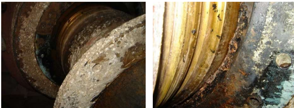
Фиг. 6. Пропадане гребен вал, м/к Saint Fanouris
