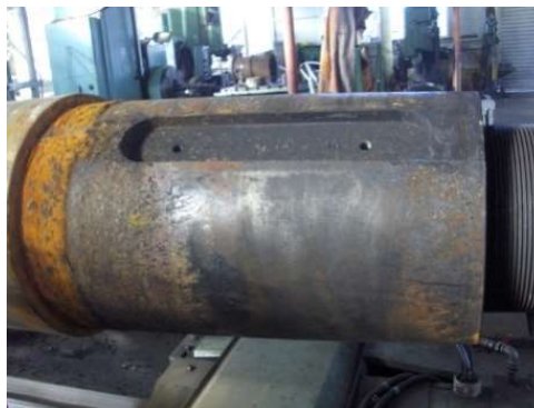
Фиг. 8. Пукнатини по конусната повърхност на гребния вал, м/к Alaya
