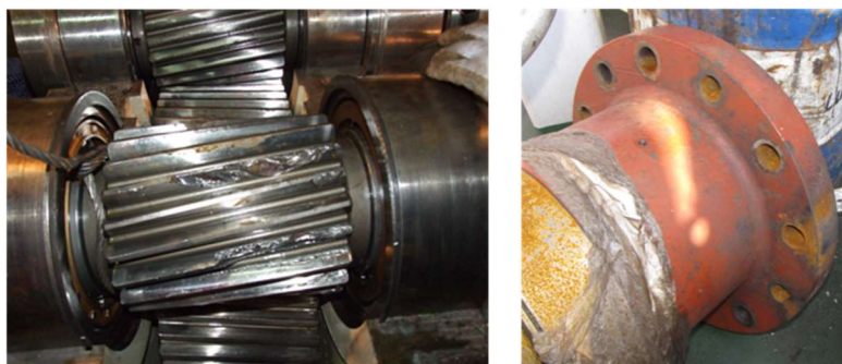
Фиг. 12. Открити дефекти – изронени зъби на пиньона на пропульсивния редуктор и износени отвори на фланеца, м/к Michelle 1
