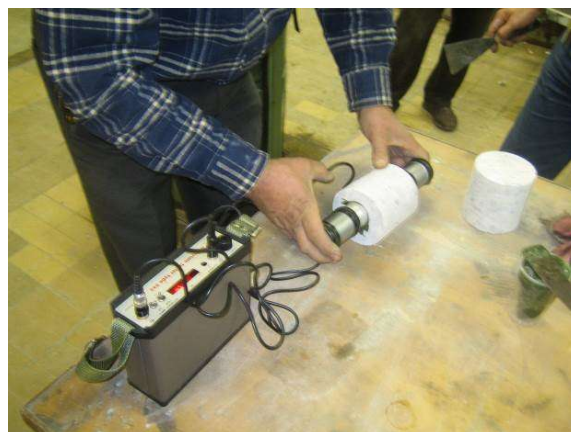
Фиг. 3.35 и 3.36 Моменти от ултразвукови изследвания на изрязани бетонни пробни тела
