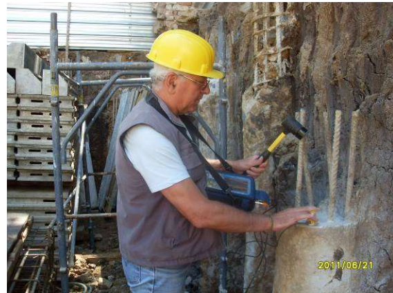
Фиг. 3.19 и 3.20 Моменти от проведените ултразвукови изследвания: на скоростта в бетона (ляво) и на интегритета на пилотите (дясно)
