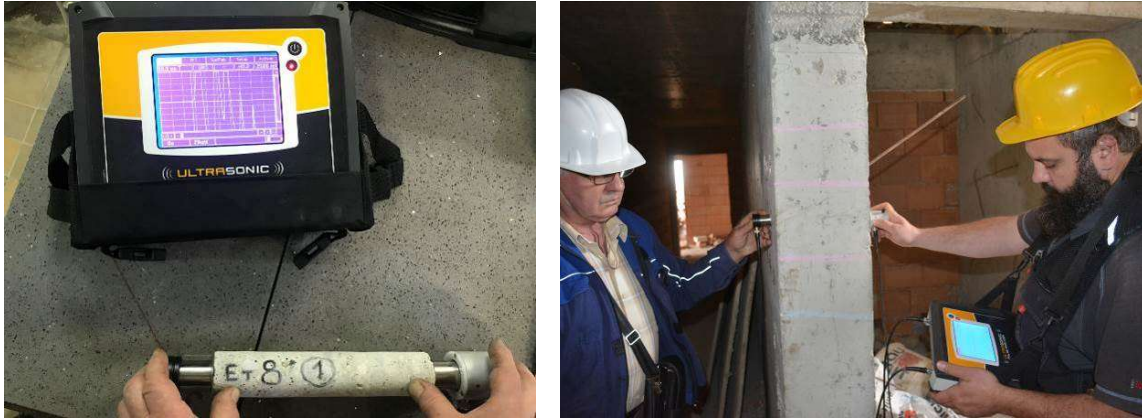
Фиг. 3.41 и 3.42 Ултразвукова диагностика на сондажни ядки и на монолитна шайба с повърхностни дефекти на 8 етажна сграда в гр. София (2018г.)
