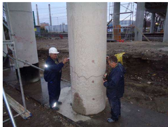
Фиг. 3.33 и 3.34 Моменти от проведените ултразвукови изследвания на еднородността и якостно-деформационните характеристики на бетона в ст.б. колони на Пътен надлез Стамболийски (2017г.)
