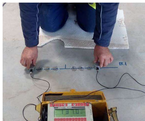
Фиг. 3.31 и 3.32 Ултразвукова диагностика на проявени пукнатини в плочите на Мегапарк София (ляво) и в индустриалната безфугова настилка на ЛИДЛ Кабиле (дясно)
