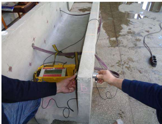
Фиг. 3.27 и 3.28 Ултразвуково прозвучаване за окачествяване на монтажни бетонни канавки ЕКТ 200/50 (ляво) и перонни елементи ПЕМ 76 (дясно)
