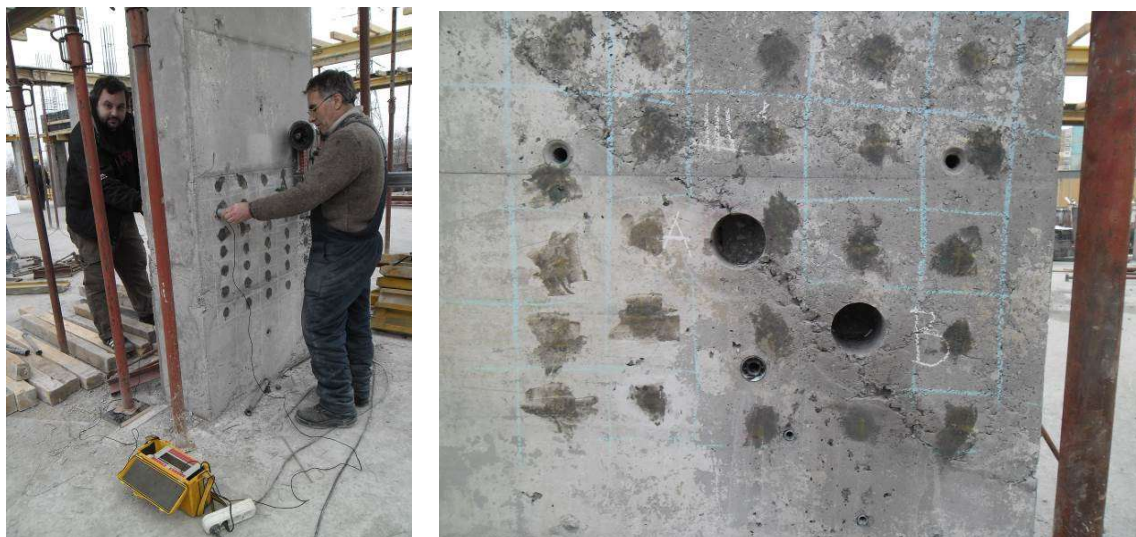
Фиг. 3.37 и 3.38 Моменти от провеждани ултразвукови изследвания за окачествяване на ст.б. стени в новостроящ се цех за захарни изделия в гр. София (2014г.)
