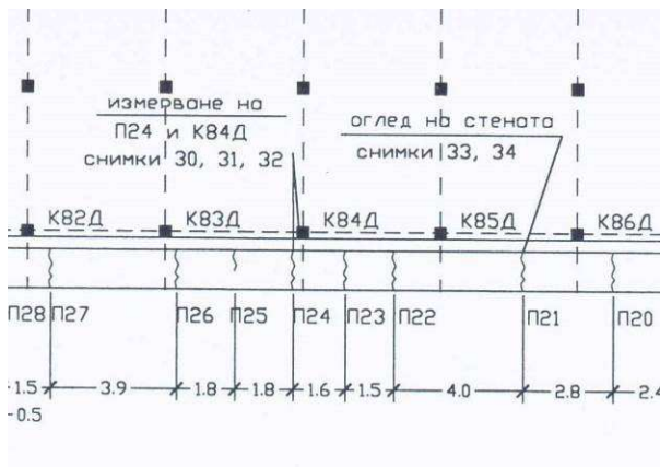
Фиг. 3.11 и 3.12 Фрагмент на изследваната зона с пукнатини и поглед отблизо (дясно) с маркираните бази за измерване на дълбочината им чрез ултразвуково прозвучаване
