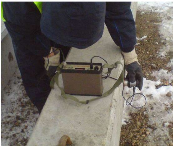
Фиг. 3.29 и 3.30 Ултразвуково прозвучаване за окачествяване на набивни ст.б. пилоти (ляво) и на ст.б. столици от сглобяемите покривни конструкции на магазините БИЛЛА (дясно)
