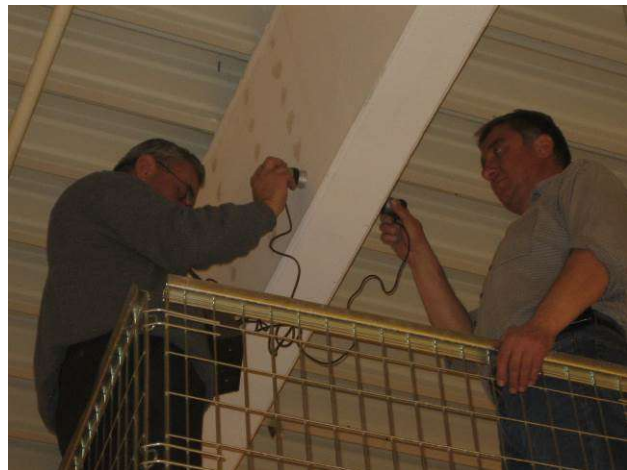
Фиг. 3.29 и 3.30 Ултразвуково прозвучаване за окачествяване на набивни ст.б. пилоти (ляво) и на ст.б. столици от сглобяемите покривни конструкции на магазините БИЛЛА (дясно)
