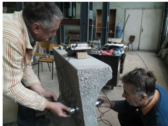
Фиг. 3.27 и 3.28 Ултразвуково прозвучаване за окачествяване на монтажни бетонни канавки ЕКТ 200/50 (ляво) и перонни елементи ПЕМ 76 (дясно)
