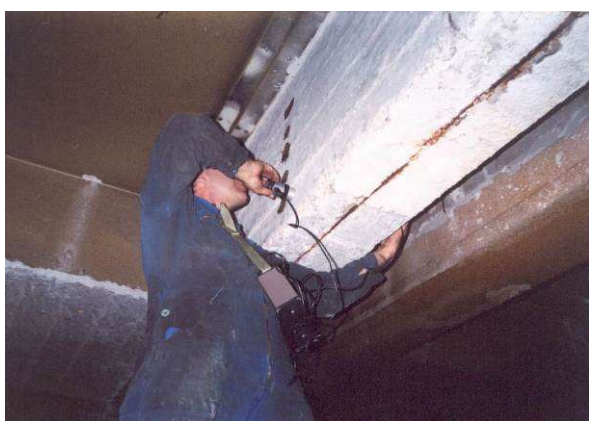
Фиг. 3.13 и 3.14 Ултразвукова диагностика на бетона в гредите и на степента на корозия (нетната дебелина) на стоманените части от колоните на „Ротондата“ пред Централна гара София
