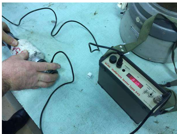
Фиг. 3.35 и 3.36 Моменти от ултразвукови изследвания на изрязани бетонни пробни тела
