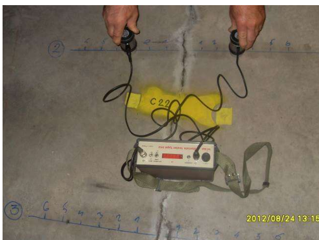
Фиг. 3.31 и 3.32 Ултразвукова диагностика на проявени пукнатини в плочите на Мегапарк София (ляво) и в индустриалната безфугова настилка на ЛИДЛ Кабиле (дясно)
