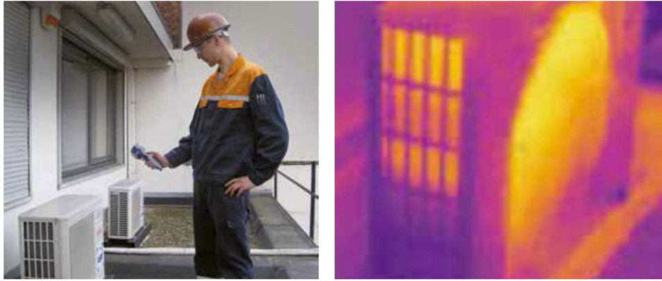
Фиг. 28 и 29 Външен вид и термокартина на недобре функциониращо външно тяло на климатична система
