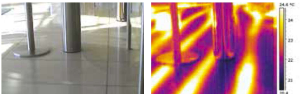
Фиг. 21 и 22 Подобни външен вид и термокартина, показваща също проблеми в подовото отопление
