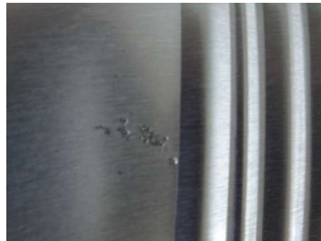
Фигура 3. Пример за корозионен процес, преминал от вътрешната към външната страна на опаковката
