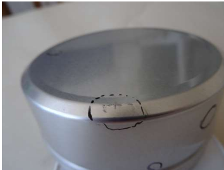
Фигура 1. Корозионни изменения по външна повърхност, която не е била в пряк контакт с продукта
